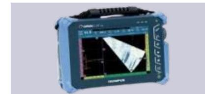
Ultrasonido avanzado usado para la detección de defectos en materiales. Uso de múltiples elementos en un transductor para diferentes secuencias, controlando el haz y dirección del ultrasonido.
