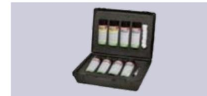
Ensayo para detección de indicaciones abiertas a la superficie en una variedad de materiales no porosos como metales, plásticos, cerámicos y vidrios. Insumos MAGNAFLUX.
